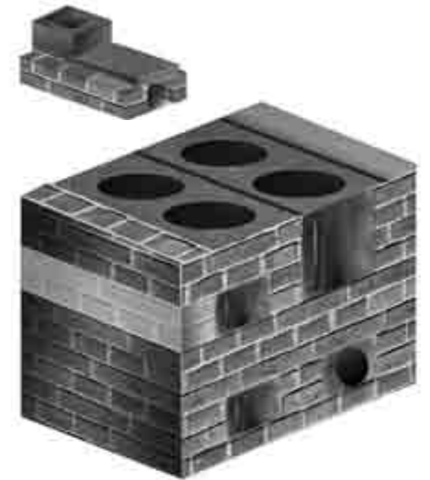
Figura 6. Perfil isométrico y cámara de combustión de la estufa FN
